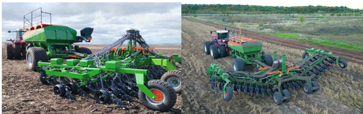
Рис.2. Сеялка Discara 9000-С фирмы АО «Ам-Техника» (г. Самара) для влаго-ресурсосберегающих технологий Mini-Till (No-Till): а) - общий вид, б) – моно-дисковые сошники, в) – сеялка Discara 9000-С в работе при «прямом» посеве по предшественнику - подсолнечник; г) - сеялка Discara 12000-С в работе при по предшественнику - нут
