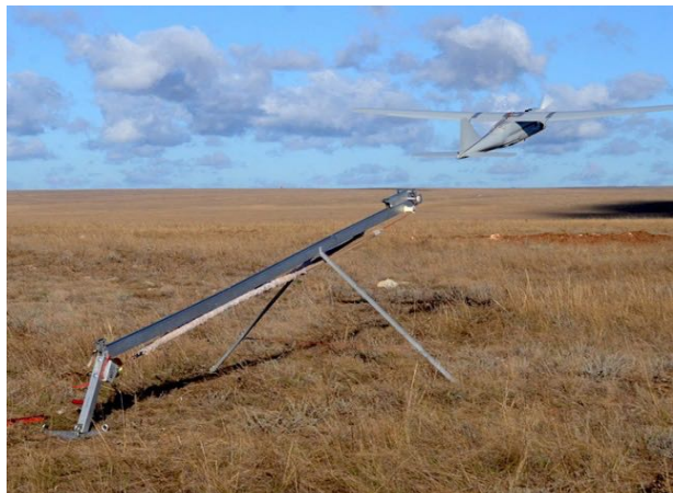
Рис. 3. Катапультирование БПЛА самолетного типа
