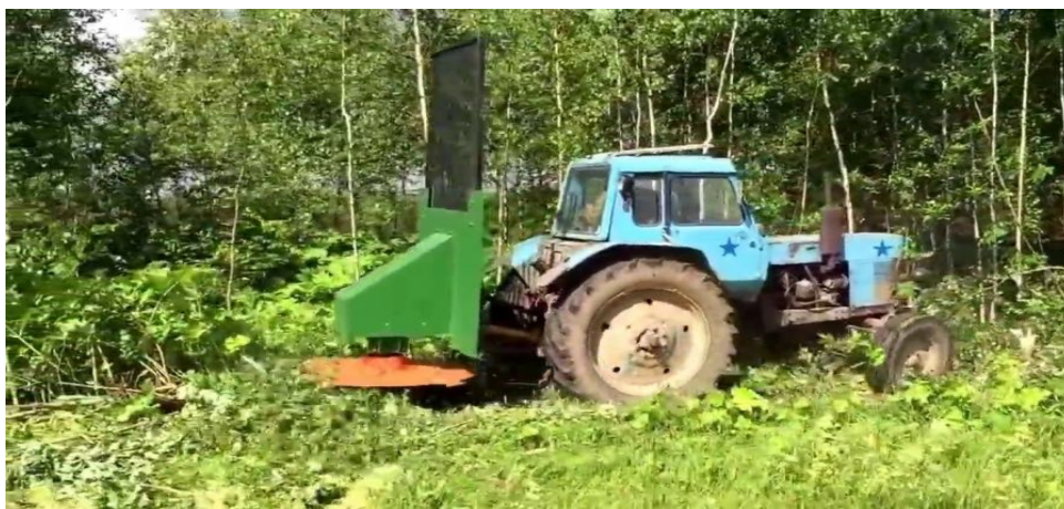
Рисунок 6. Кусторез, работающий с подвижной стрелой на базе трактора МТЗ-80
