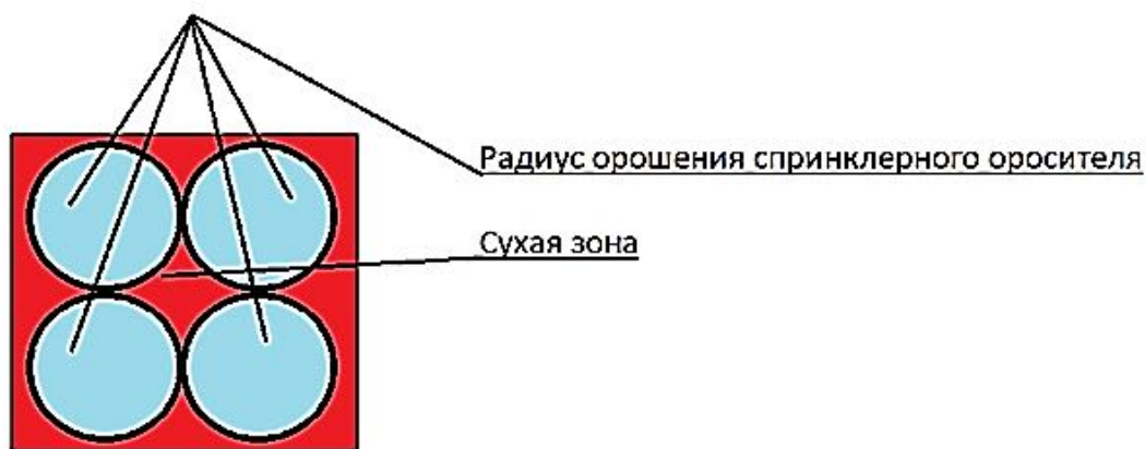
Рисунок 1. Проекция «Сухих зон» на орошаемой поверхности при проектировании АУПТ, исходя только из соприкосновения проекций радиусов орошения спринклерных оросителей.
