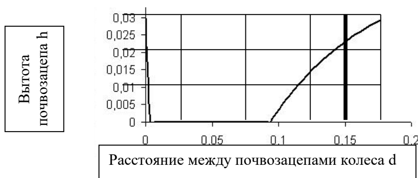
Рисунок 3 – Траектория движения очистителя между почвозацепами колеса ДМ «Фрегат»
