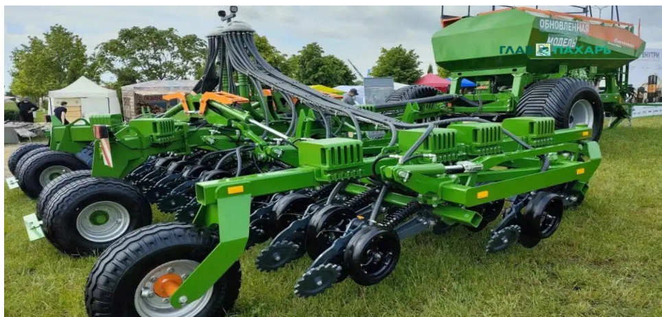
Рис.1. Обновлённый посевной комплекс Amazone Discara 9000-C с шириной захвата 9 метров на выставке «Золотая Нива 2026» (открытые источники).
