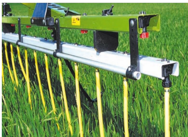
Рис.1. Внесение жидких удобрений: а)- удлинительными шлангами штанговым опрыскивателем; б)- следы КАС-32 на почве после 2-х кратного внесения
